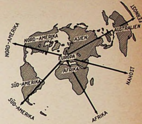
Bild 1. Hauptstrahlrichtungen der Groß-Senderanlage „Deutsche Welle“
