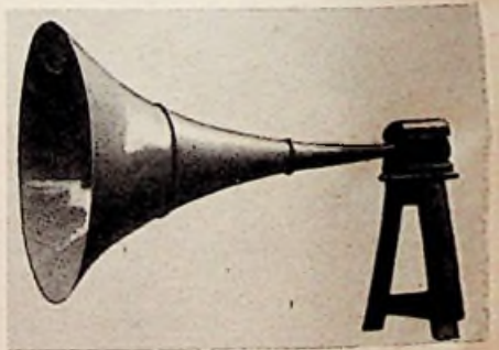
Bild 9. Dynamischer Großlautsprecher mit 8 m langem Trichter für 5 kW Sprechleistung (etwa 1925)
