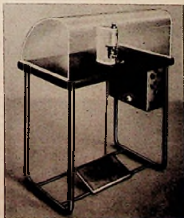
Bild 1. Neue vollelektronische Präzisions-Punktschweißmaschine mit durchsichtiger Staubschutzhaube
