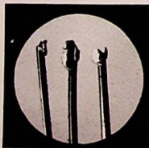
Mikroaufnahme zerfressener Kupferlackdrähte
