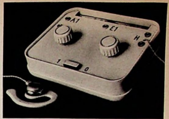
Bild 1. Transistor-Empfänger E 551. An der Oberkante erkennt man die beiden Batterien, links die Antenneneinbuchsen, rechts die Kopfhörerschnur und zwei zusätzliche Hörerbuchsen, in der Mitte die beiden Drehknöpfe für die Abstimmkondensatoren und vorn den Griff für einen Schiebeschalter
